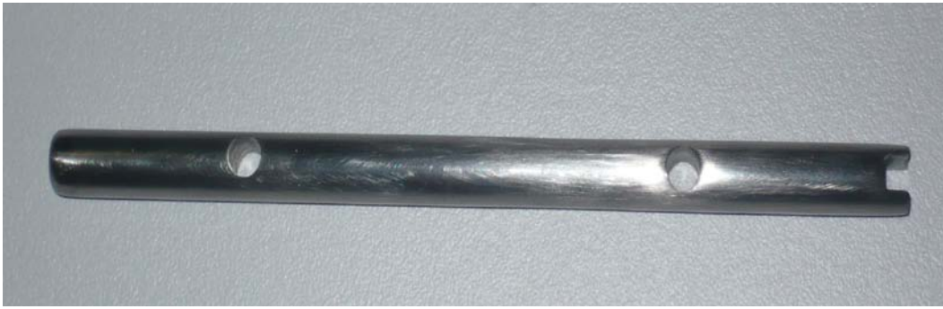
Fig. 6.1. Modelo construido del clavo intramedular para fijación de fractura de húmero.
