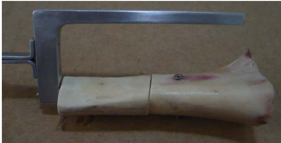
Fig. 6.6 Colocación del tornillo en la zona distal del clavo intramedular
