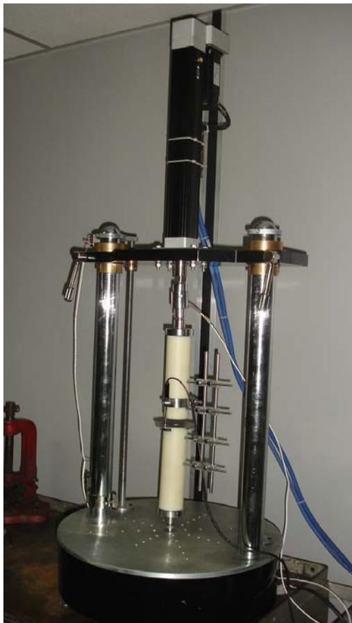
**Figura IV.1** Banco de ensayos para dispositivos de Osteosíntesis, ensayando un fijador externo ATLAS para tibia en configuración monoplanar. (Fuente: Propia).
