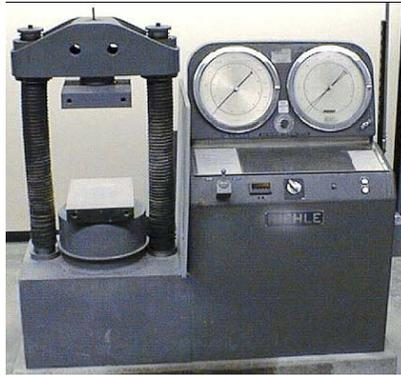
**Figura 2.11** Máquina RIEHLE MCA-300 (Coe.montana, 2009).
