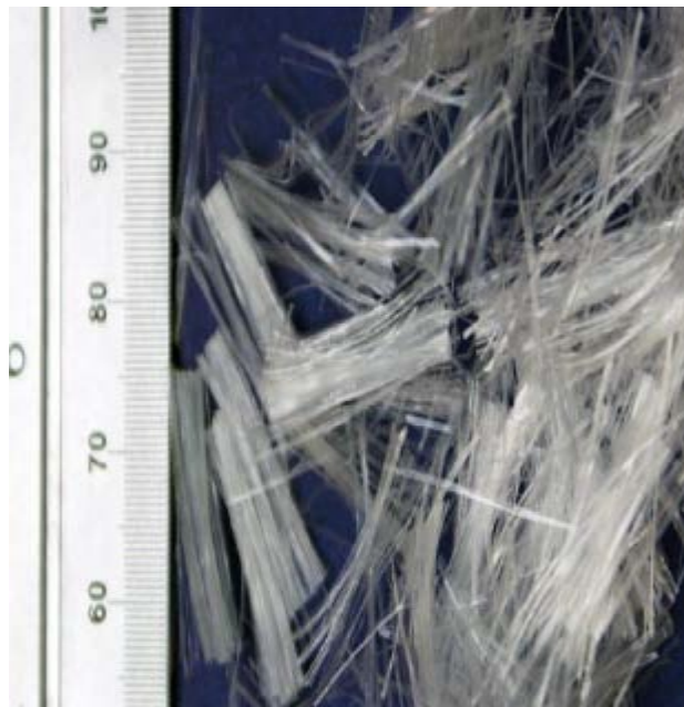
Figura 6. Microfibra de polipropileno. Fuente: col.sika.com
