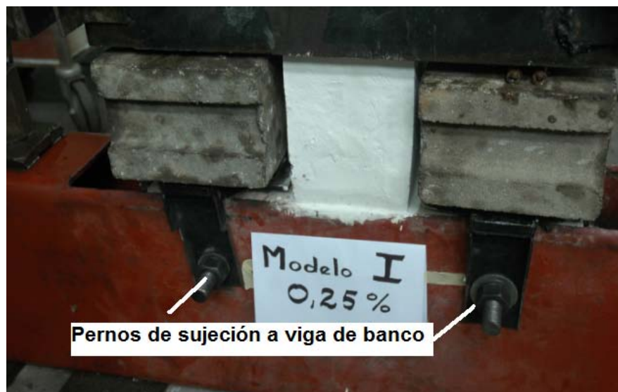
Figura 11. Sujeción de espécimen a viga de banco. Fuente: elaboración propia
