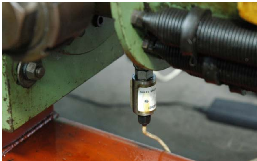
Figura 13. Celda de presión típica ubicada en uno de los gatos hidráulicos. Fuente: elaboración propia
