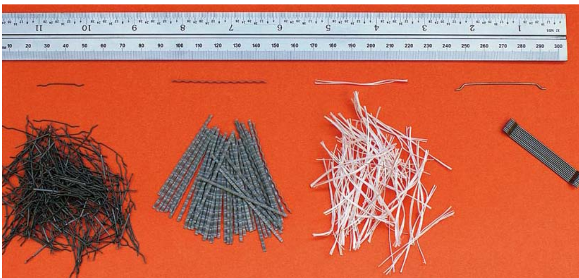
Figura 7. Diferentes tipos de macrofibras. Fuente: col.sika.com
