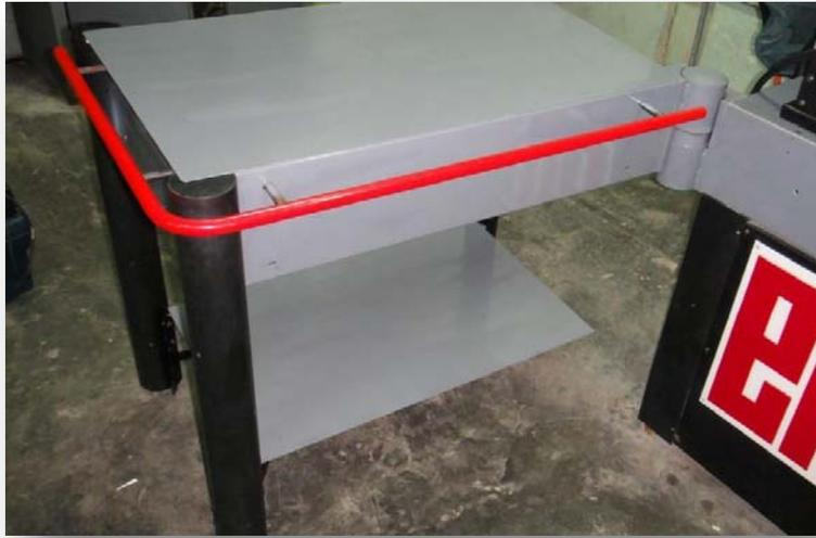
**Figura 4.1.16.** Acondicionamiento de la mesa con 2da repisa, para la estación de control
