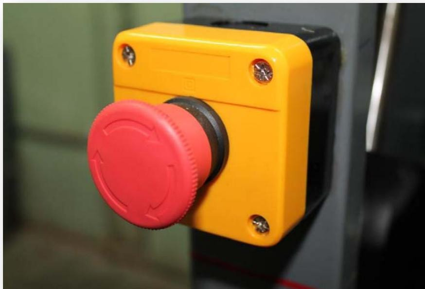
**Figura 4.1.24.** Botón de Parada de Emergencia anexo a la estación de mecanizado.
