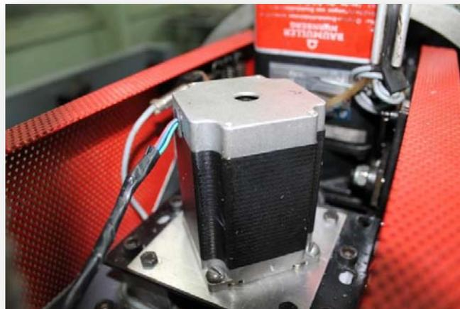
**Figura 4.1.21.** Motor De Paso Nuevo que controla los movimientos en el eje Z.
