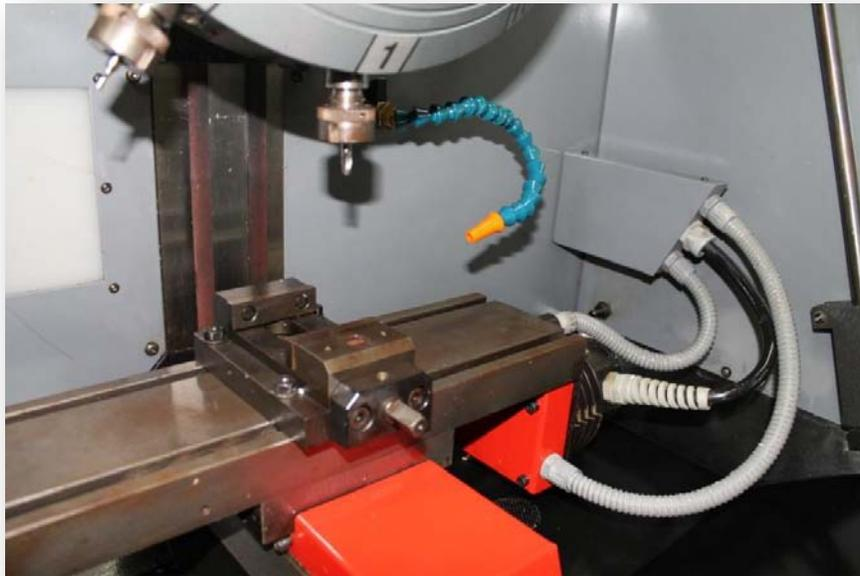
**Figura 4.1.32.** Mesa de trabajo y componentes lubricados.
