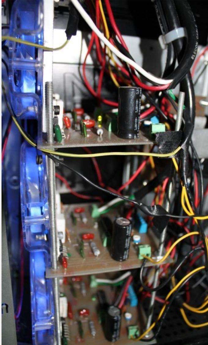
**Figura 4.1.19.** Tarjetas electrónicas controladoras de los motores X, Y y Z
