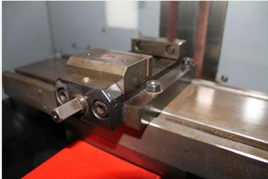
**Figura 4.1.31.** Mordazas y mesa de mecanizado tras labores lubricación y remoción de oxido
