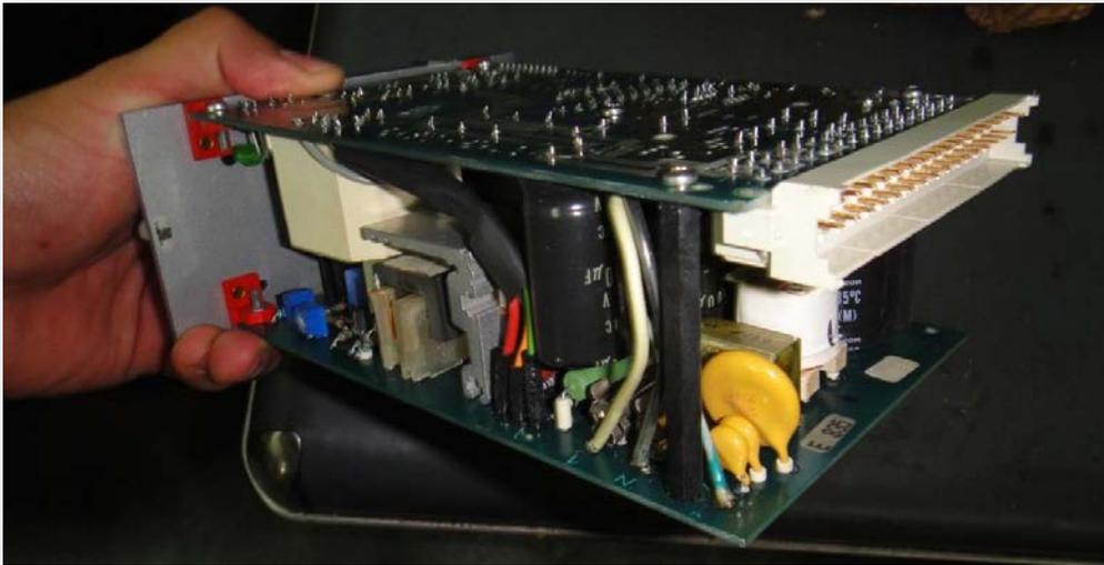
**Figura 4.1.14.** Fuente De Poder del equipo después de realizarse labores de reparación.
