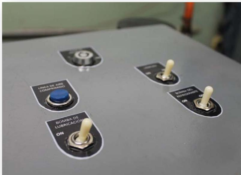
**Figura 4.1.26.** Tablero de interruptores instalado a la estación de control.
