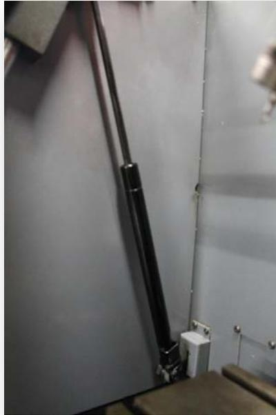
**Figura 4.1.33.** Amortiguador nuevo, de las compuertas de la estación de mecanizado.
