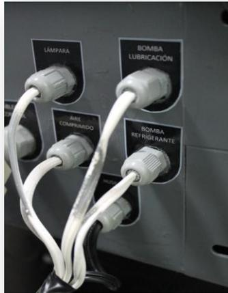
Figura 4.1.27. Adaptación al cableado original de las bombas, líneas de aire, iluminación y husillo.
