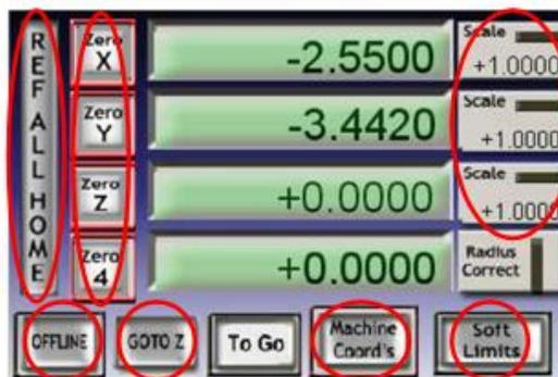
**Figura 2.2.5.** Sección de posición y estado de los ejes:
