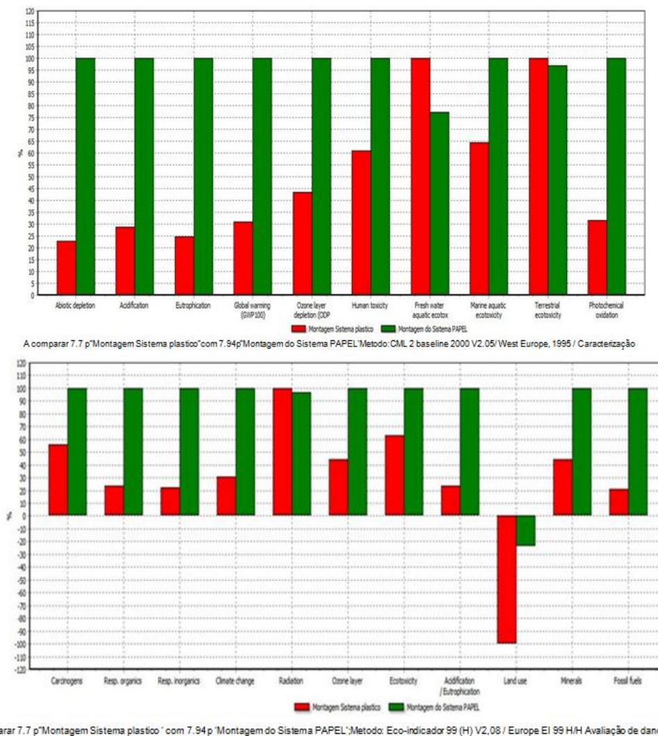
Figura 7: Comparação dos impactos ambientais da embalagem de plástico e embalagem de papel - Modelo CML 2000 e Eco-Indicador 99 (H).
