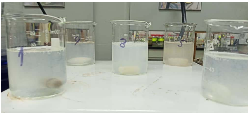
Figura 130. Proceso de clarificación de efluente industrial (inicio del proceso).
