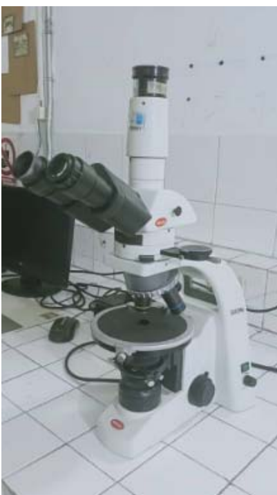
Figura 36. Microscopio de Polarización MOTIC BA310 POL trinocular
