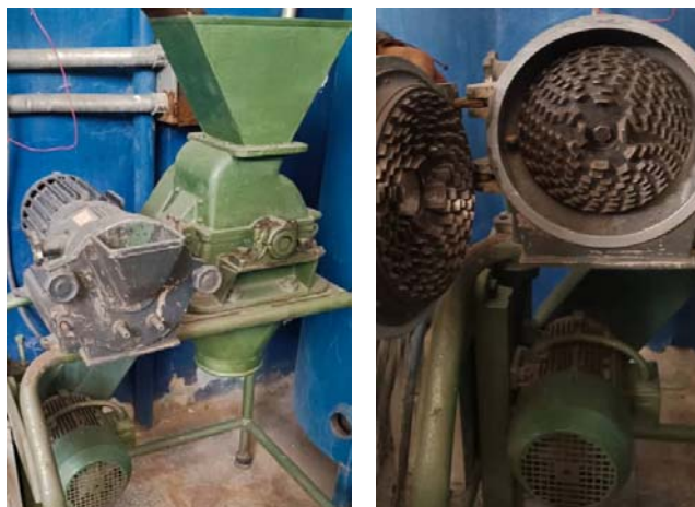
Figura 22. Molino tipo helicoidal (izq: vista exterior general, der: vista del sistema interno de molienda)
