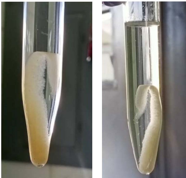
Figura 57. Etapa de lavado/centrifugado del 2,3 DAC proveniente de las distintas celulosas (izq: de megathyrus maximus, der: comercial)
