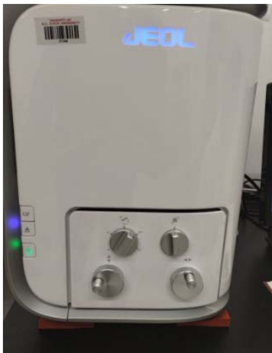
Figura 37. Equipo JEOL para microscopía electrónica de barrido
