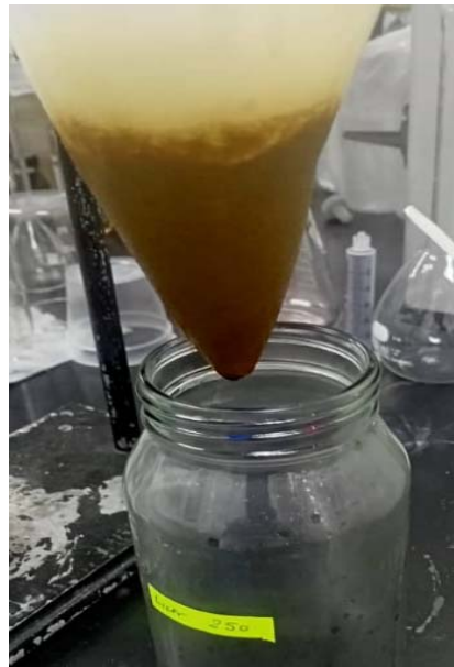
Figura 25. Proceso de lavado/filtración durante la deslignificación de Megathysus maximus
