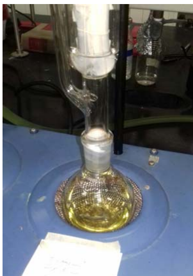
Figura 46. Equipo Soxhlet de extracción sólido-líquido
