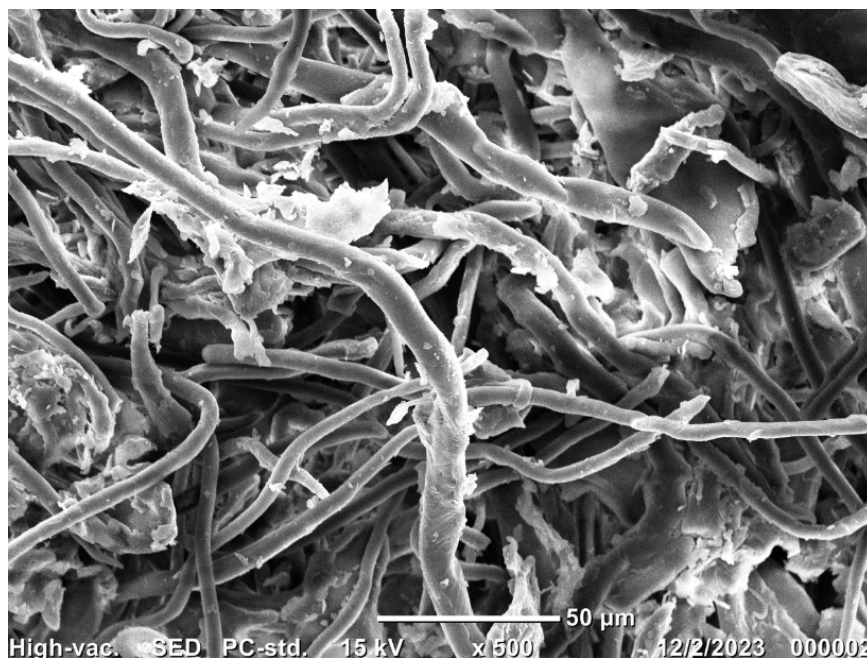
Figura 112. Microscopía electrónica de barrido de 2,3 DAC de Megathyrus maximus (500x)
