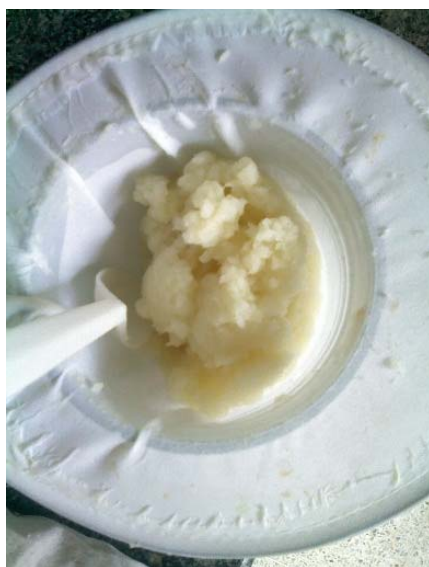
Figura 52. Filtración de la etapa de blanqueo del Megathyrus maximus
