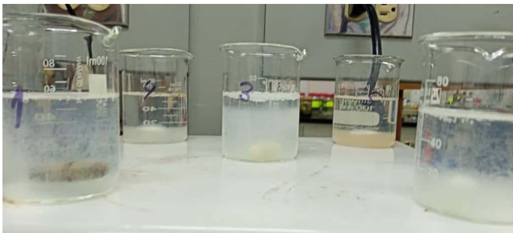
Figura 131. Proceso de clarificación de efluente industrial (tiempo intermedio).
