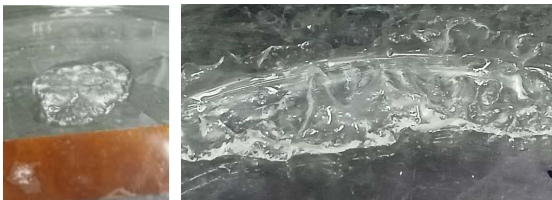
Figura 138. Películas de DCC hinchadas por absorción de agua.
