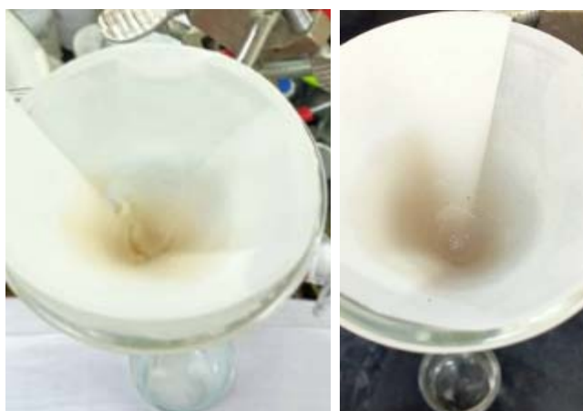
Figura 134. Flóculos húmedos retenidos posterior al proceso de clarificación. izq: tanques, der: tambores
