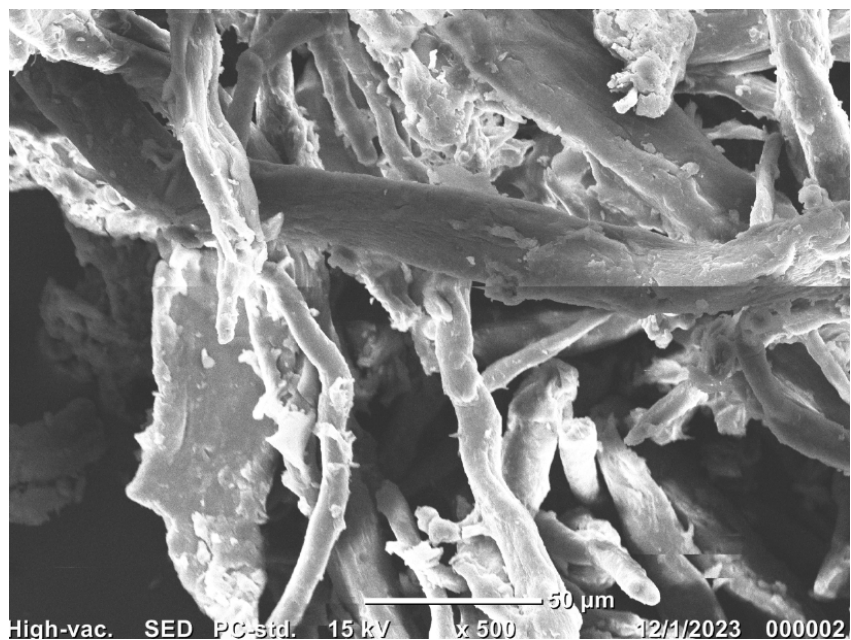
Figura 114. Microscopía electrónica de barrido de 2,3 DAC de celulosa comercial (500x)
