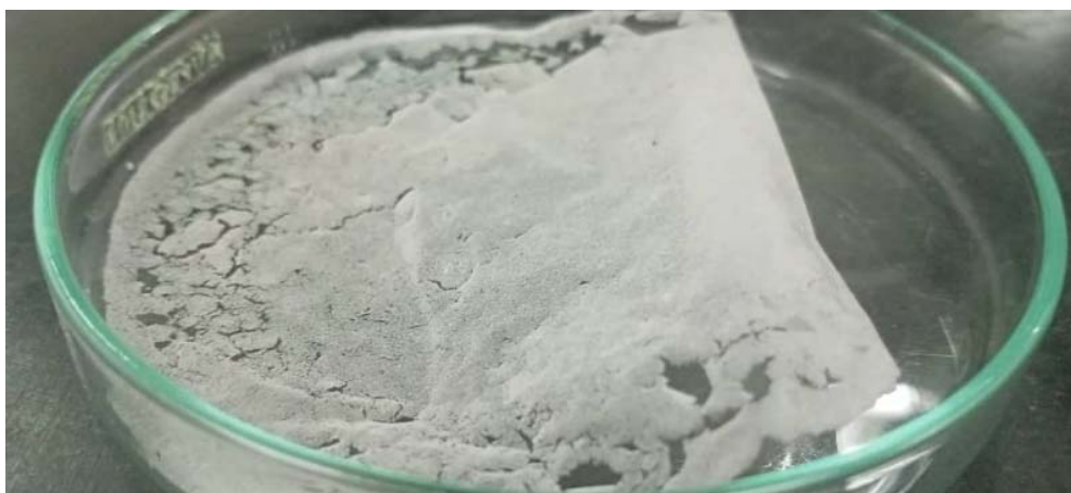
Figura 62. Película seca de 2,3 DCC proveniente de MM.
