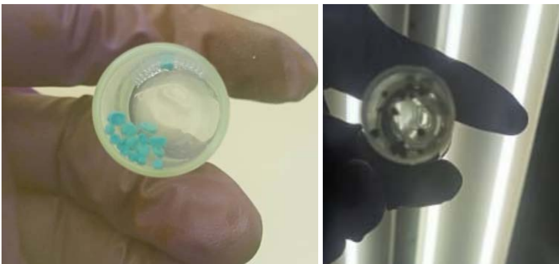
Figura 129. Cápsulas (perlas de celulosa) CMC-ion metálico en agua. Izq: CMC-Cu 2+ , der: CMC-Fe 3+
