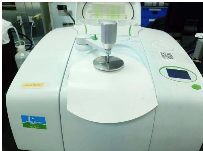
Figura 35. Espectrofotómetro de FTIR Perkin Elmer
