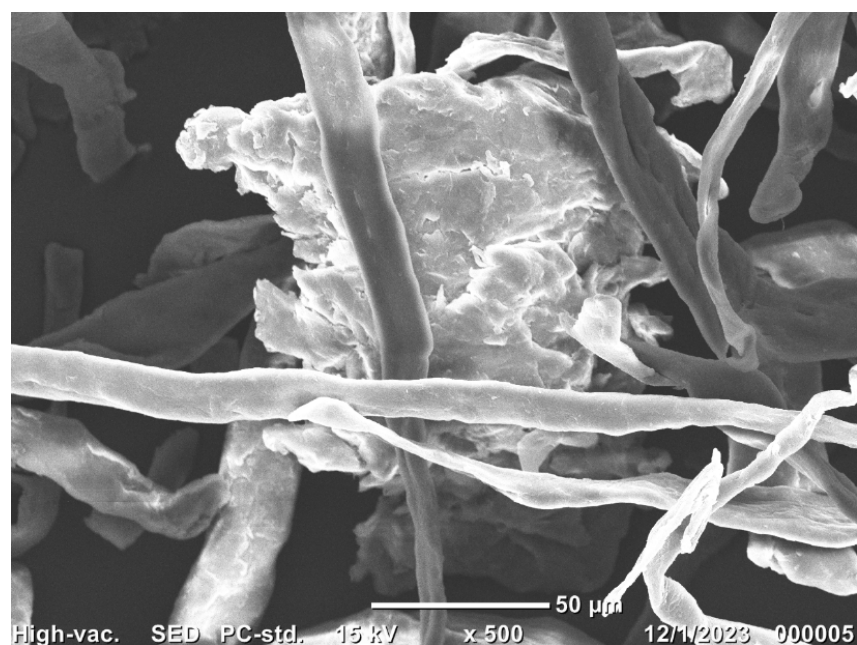
Figura 74. Microscopía electrónica de barrido de celulosa comercial (500x)
