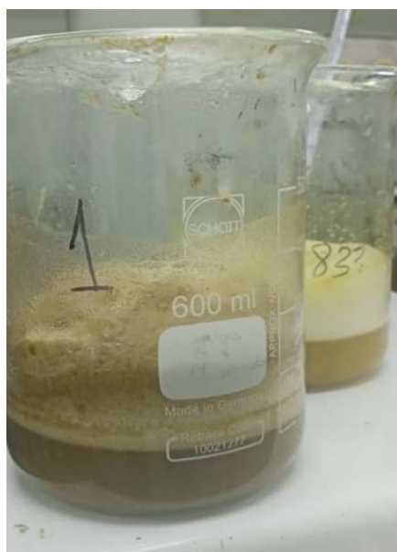
Figura 26. Proceso de blanqueo de Megathyrsus maximus
