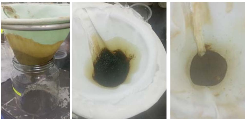
Figura 49. Filtración/lavado de la deslignificación de Megathyrsus maximus
