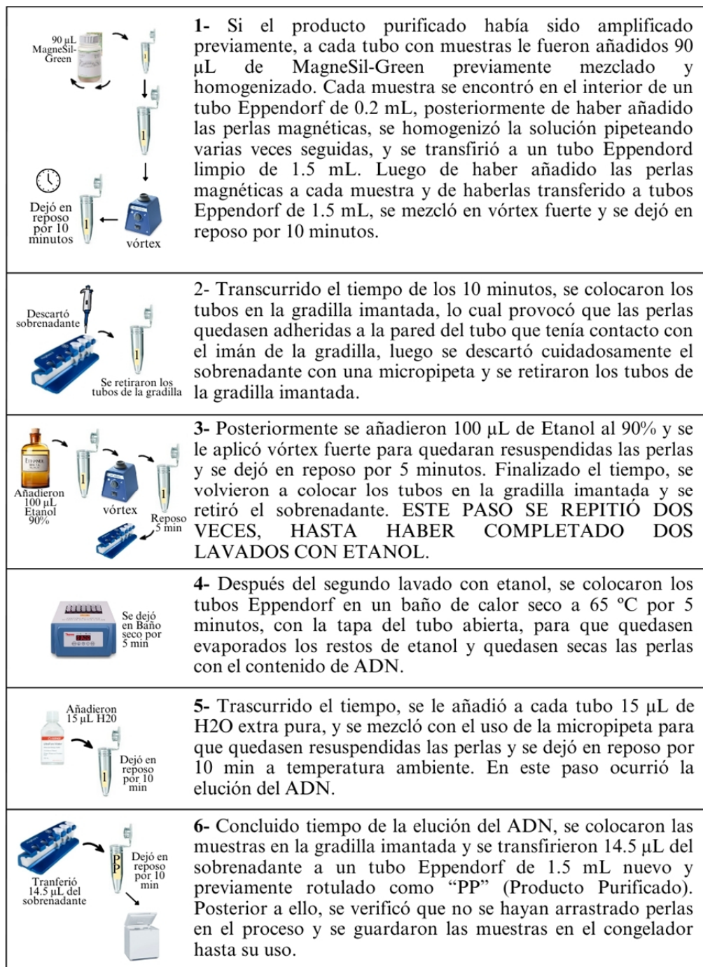
Figura 4A: Protocolo de Purificación por Perlas Magnéticas con solución MagneSil-Green para producto amplificado. Tomado de Promega, MagneSil Sequencing Reaction Clean-Up System 2010 (25) . Elaborado por Marquines, Paredes. 2024.
